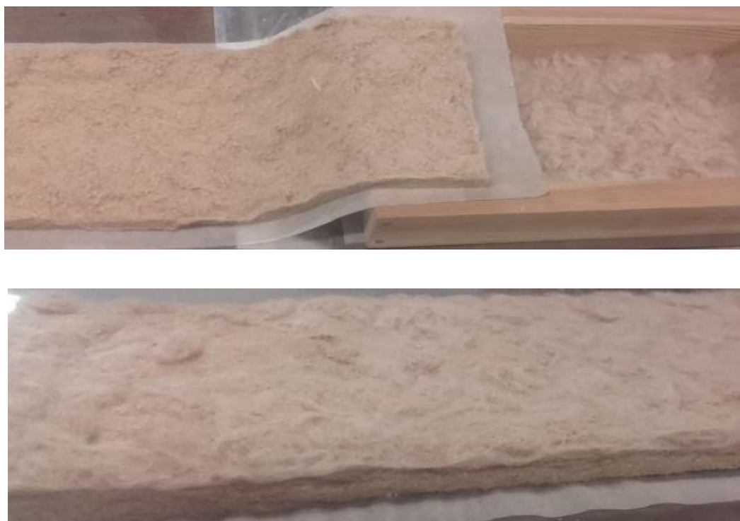
Obr. 10: Vrstvenie kompozitu drevovlákn/ PP: a) pohľad na pridávanie stredovej vrstvy, b) trojvrstvý koberec.
