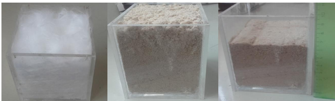
Obr. 2: Stanovenie objemovej hmotnosti vstupných materiálov: a) zhutnená PP vata s objemovou hmotnosťou 0,048 g/cm 3 , b) voľne sypané-vibrované drevné vlákno s objemovou hmotnosťou 0,075 g/cm 3 , c) zhutnené drevné vlákno s objemovou hmotnosťou 0,125 g/cm 3 .
