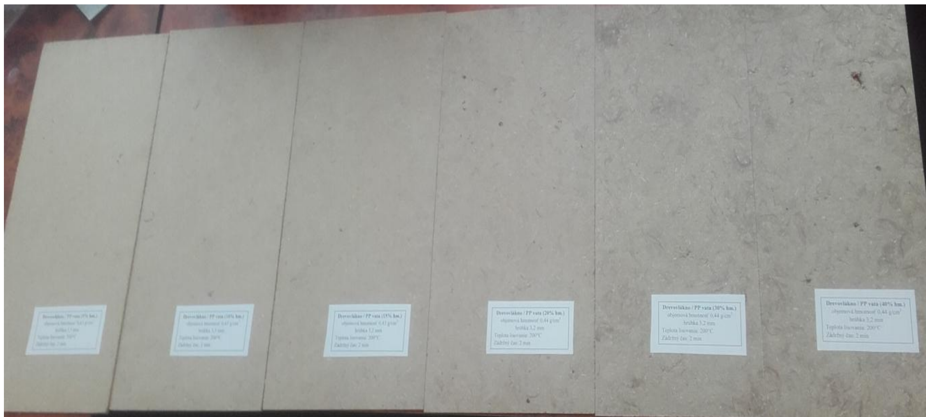
Obr. 8: Laboratórne vyrobené tenké kompozity drevné vlákno/PP hrúbky 3,2 mm. Obsah polypropylénu 5, 10, 15, 20, 30 a 40%.
