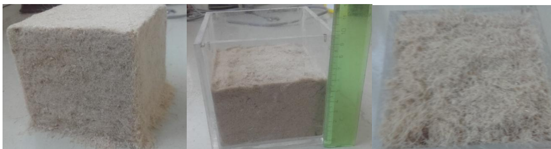
Obr. 4: Drevné vlákno zmiešané s PP vatou: a) 1:3 (obj./obj.), objemová hmotnosť 0,066 \text{ g/cm}^3 , b) 1:3 zhutnené do odpruženia, objemová hmotnosť 0,110 \text{ g/cm}^3 , c) detail na povrch voľne sypaného vlákna.
