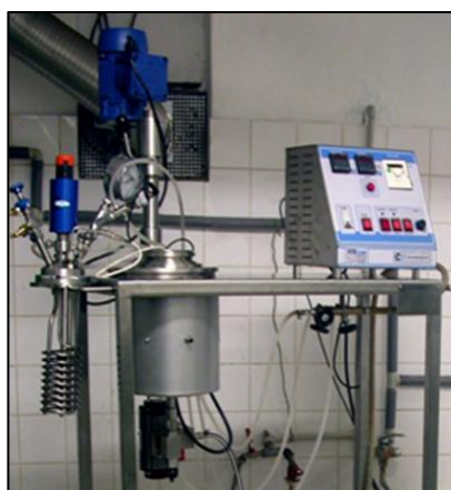
Obr.6 Tlakový reaktor s tlakovou nádobou (STEX).
