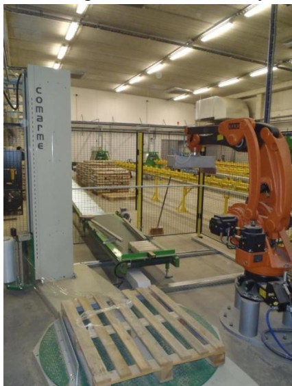
Obr.40 Baliaca linka drevených brikiet
