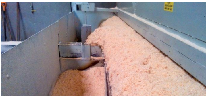
Obr.42 Výstup zo sušičky drevných častíc s vlhkomerom
