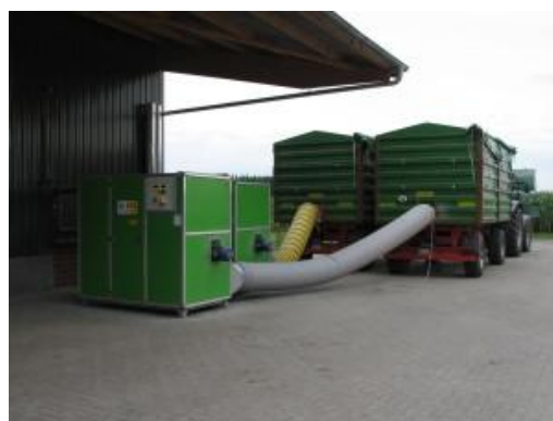
Obr.34 Nákladné auto suší drevenú štiepkku odpadovým teplom z bioplynovej stanice.
