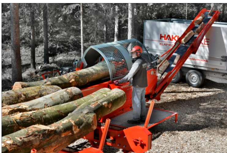
Obr.16 Procesor (štiepací automat) na výrobu palivového dreva HAKKI PILKE fy MAASELÄN KONE OY
