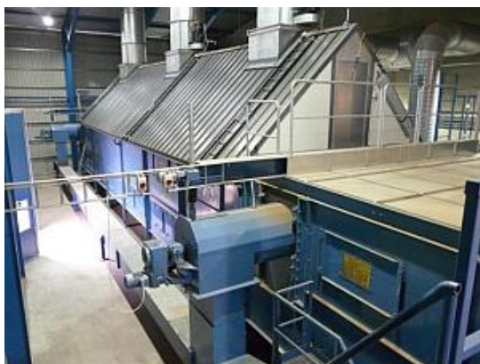
Obr.29 Stacionárna linka na výrobu energetickej štiepky fy Bruks – Klockner, Nemecko
