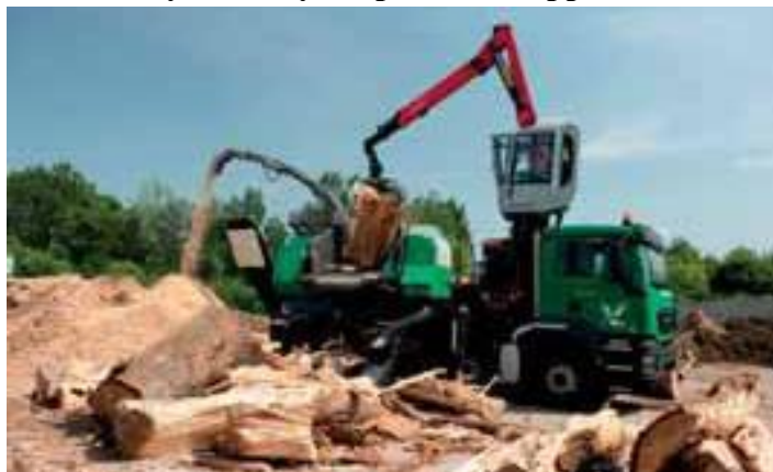
Obr.27 Univerzálny mobilný štiepkovač Chippo 5010 Cd:
