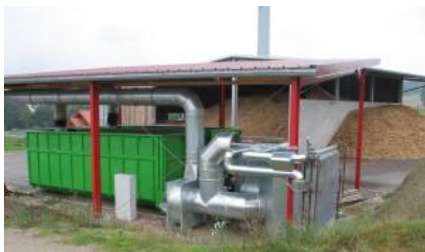
Obr.33 Kontajner pre sušenie drevenej štiepkky bioplynom .
