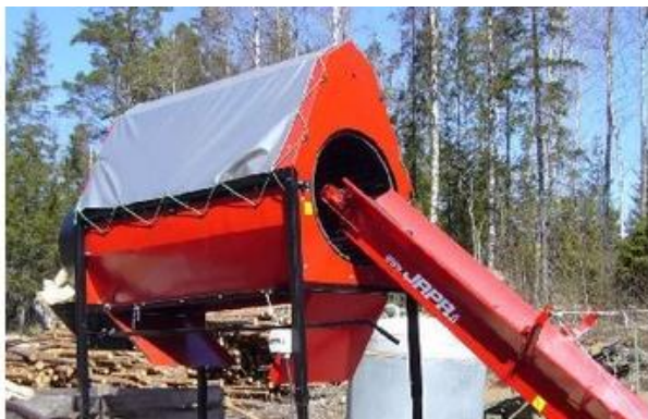
Obr. 19 Čistiaci bubon na palivové drevo Japa fy Laitilan Rautarakenne.
