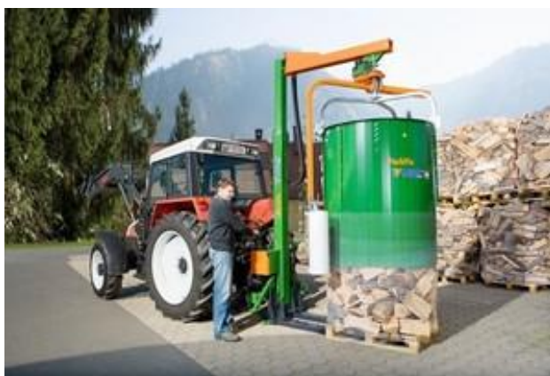
Obr.21 Adjustovanie palivového dreva do prepravných vakov na štandardnej palete pomocou valcovej formy PackFix
