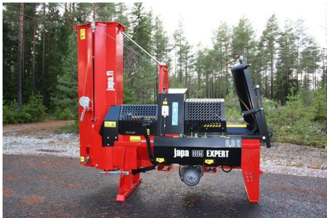
Obr.14 Skracovací a štiepací automat na výrobu palivového dreva Japa 385 fy Laitilan Rautarakenne
