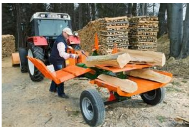
Obr.15 Skracovací a štiepací automat na výrobu palivového dreva Japa s pohonom na traktorový motor fy Laitilan Rautarakenne
