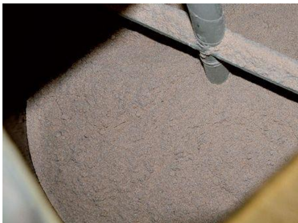
Obr.43 Miešacie zariadenie pre stabilizáciu vlhkosti drevených častíc
