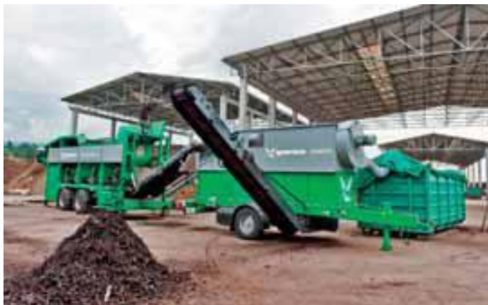
Obr.25 Separátor silikátových prímiesí Stonefex
