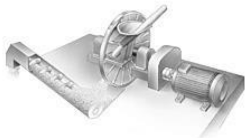
Obr.8 Kotúčová (disková) sekačka
