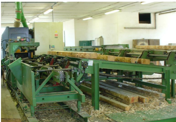
Obr.23 Spirálová redukčná sekačka Söderhamns 240-12-E a vyrobená prizma
