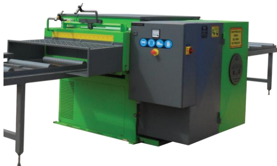
Obr.31 Skracovacia píla na rezivo WEINIG OptiCut 200 Elite
