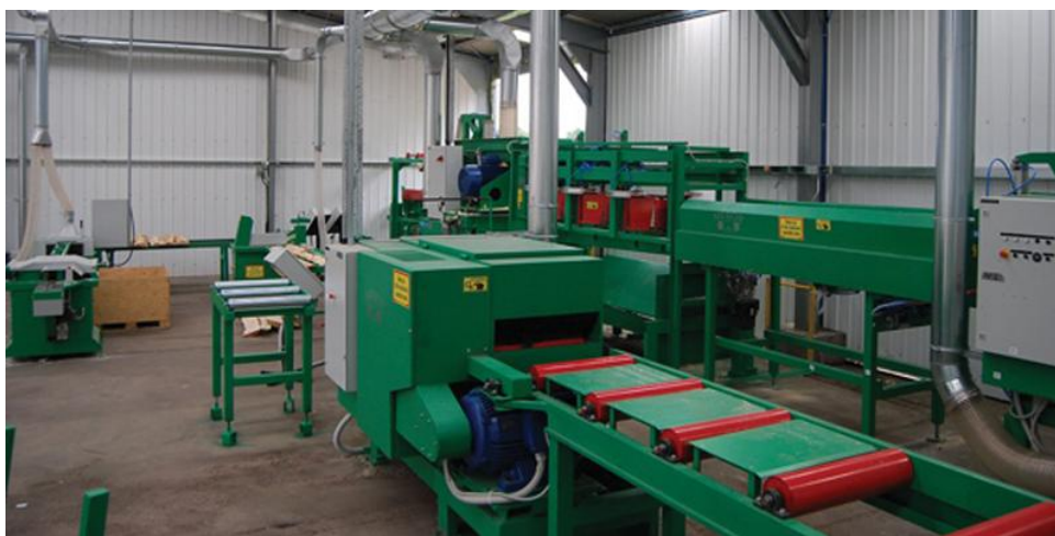
Obr.33 MEBOR linka na perez guľatiny malých priemerov
