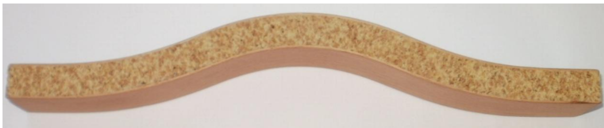
Obr.19 Elastická triesková doska Recoflex
