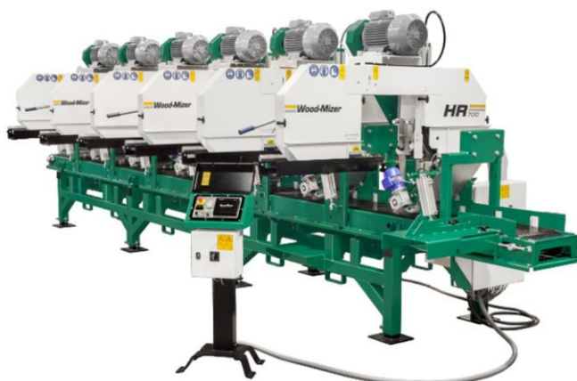
Obr.28 Modulárna rozmetacia píla na guľatinu HR700 fy Wood Mizer Modulárna konštrukcia HR700 uľahčuje rozšíriť počet rezných hláv od jednej do šesť.
