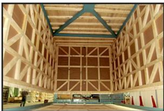
Obr.48 Vnútrotná konštrukcia dreveného obalu na prepravu strojového zariadenia
