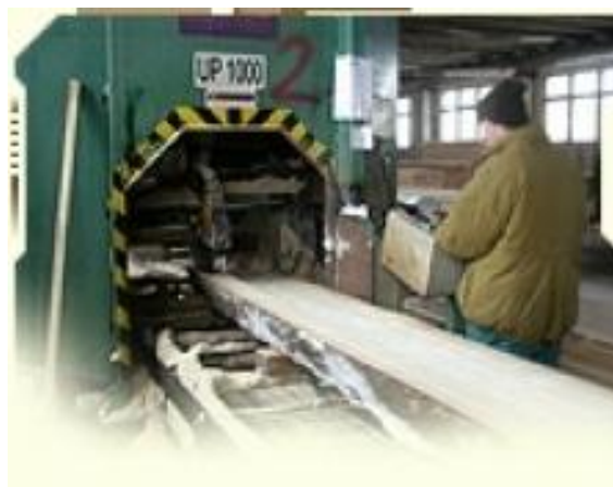
Obr.22 Porez tenkej hmoty do 40 cm na dvojici rámových píľ.
