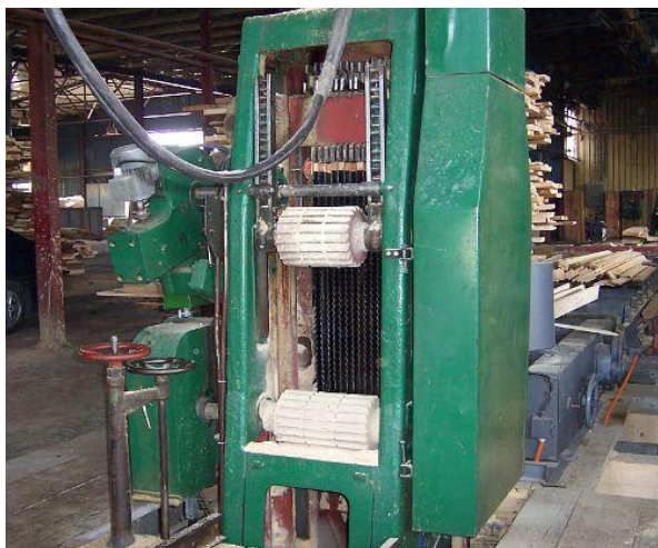
Obr.21 Rámová píla na porez guľatiny
