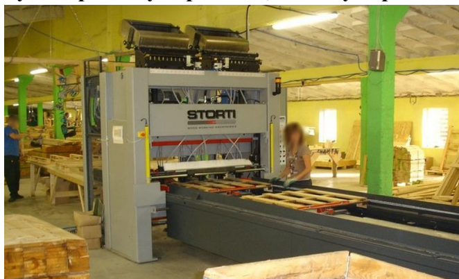
Obr.34 Automatizovaná výroba drevených paliet na paletovacom automatu fy Storti
