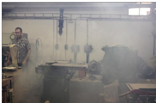
Obr. č. 2. Vznik dymu a prachu pri trieskovaní DTD s nedostatočnou vlhkosťou na zariadení f. Pallmann
