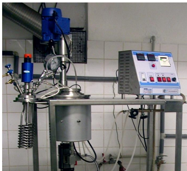
Obr. 11: Diskontinuálny parný reaktor vo VÚPC
