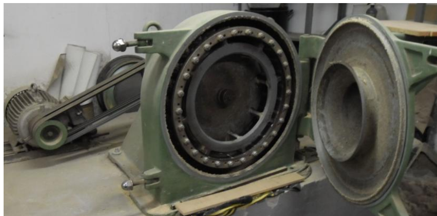
Obr. 8: Roztrieskový stroj Defibrator vo VÚPC
