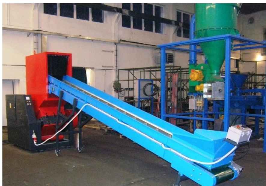
Obr.5: Nožový mlyn/drvič G 400/600 spoločnosti Terier s.r.o. s podávacím dopravníkom a odsávaním prachu
