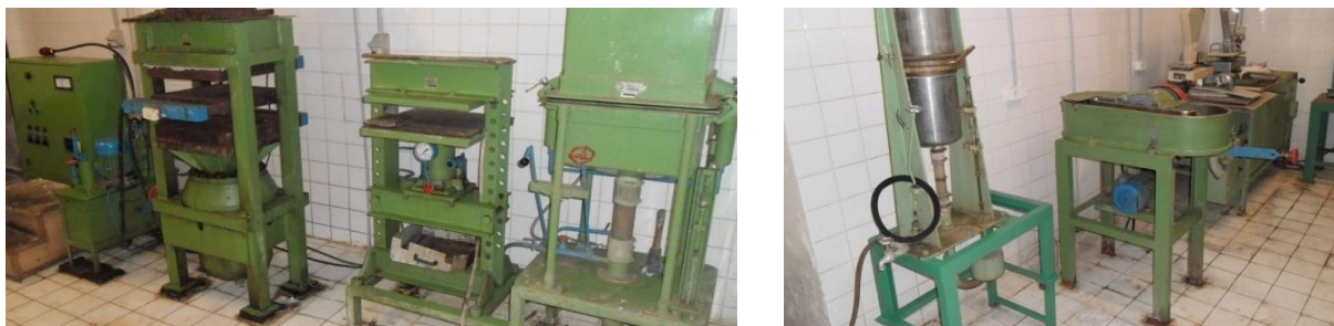
Obr.12: Poloprevádzkové diskontinuálne zariadenia na výrobu vláknitých dosiek Defibrator vo VÚPC
